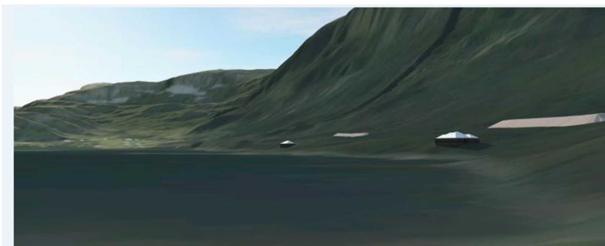
Figur 7-1 Verknad rasvollane sett frå eit nes ca. 500 meter frå staden, ståstad er vist på Figur 7-3 under.. Hyttene er lagt inn med ei høgde på 3 meter. Rasvollane er vist med lys farge for å synleggjere dei i modellen. Dei skal dekkas med stadleg masse.
