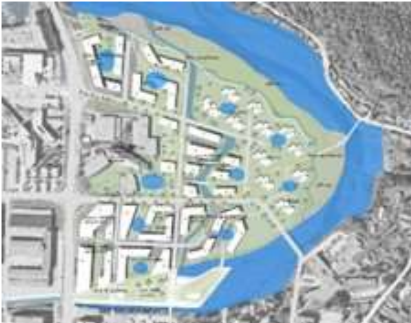
Figur 7-20: Skisse over mogleg overvassdam- og regnbedsystem. Kjelde: Link Arkitektur/Multiconsult.
