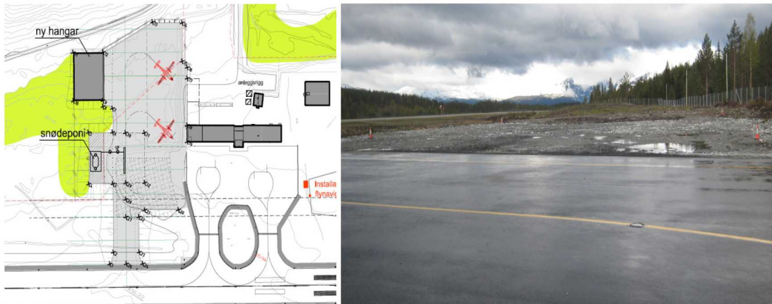
Område for ny hangar, røde kjebler viser hjørnene på en hall med bredde på 35 og dybde på 30 meter.
