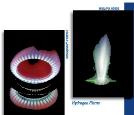
Figur 2-3 Forskjell mellom propan og hydrogenflammer
