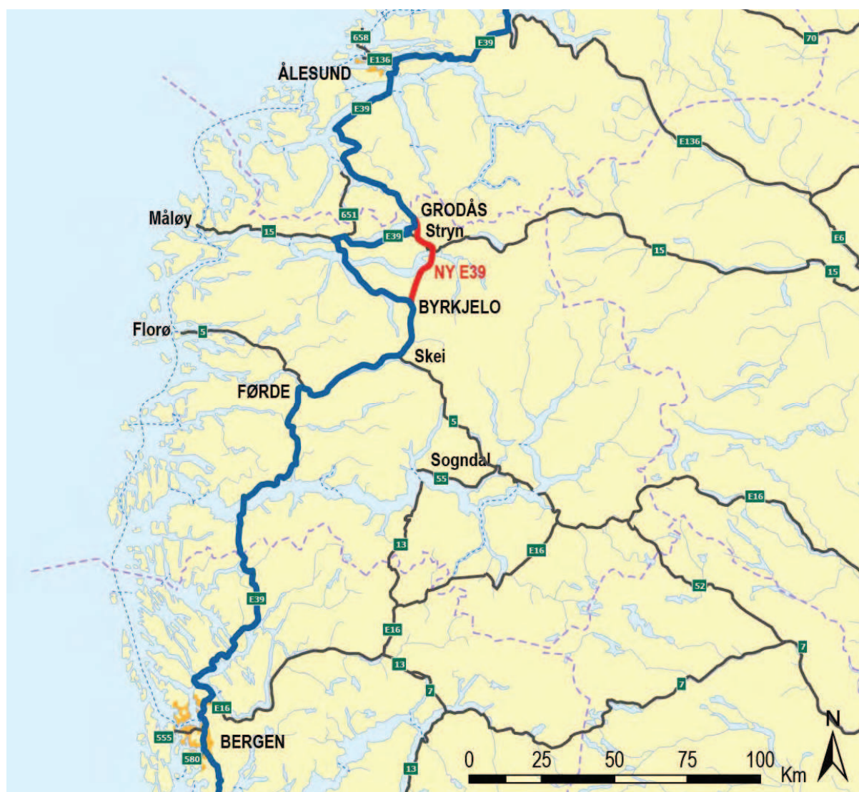
Figur 2.2: Oversikt over E39-traseen frå Bergen til Ålesund. Ny strekning frå Byrkjelo til Grodås er merka i raudt.
