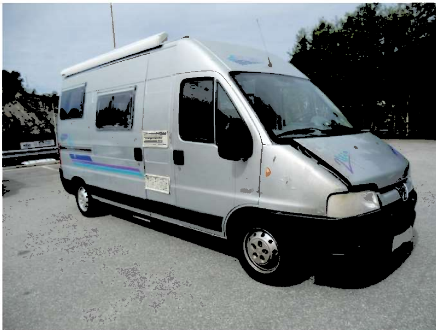
Figur 4 Fordon E som stod närmast släpet när branden startade. Det syns tydligt hur motorhuven har tryckts upp och hur strålningen har påverkat den sidan på fordonet som vände mot flammorna.
