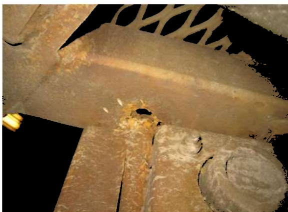
Figur 13: Rustskader i venstre dragstang. Foto: Statens vegvesen
