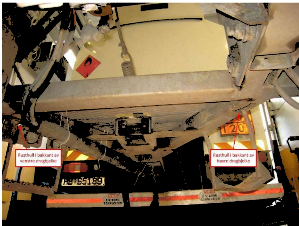
Figur 12: Rustskader i tilhengerdrag påvist i kontroll hos Statens vegvesen i mai 2011. Foto: Statens vegvesen
