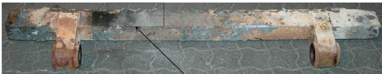
Figur 3 Bilde som viser innsveising av profil til innfestet av draget med åpning som gir fuktinntrenging på insiden av profil.
