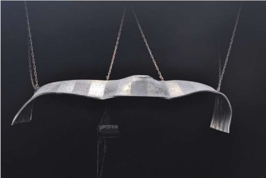
Figur 29: Høydebegrensningsskilt i aluminium ved tunnelportalen ved Hamnen med tydelige deformasjonsskader som følge av varmepåvirkning. Foto: Statens vegvesen
