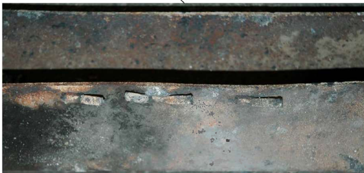
Figur 4 Bilde av drag som viser sveisepunkter og restbiter av nettingen.
