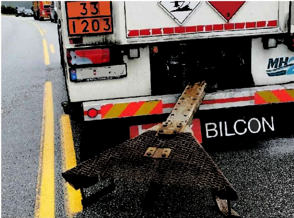
Figur 2: Rester av tilhengerdraget festet til trekkbilen, etter at det var røket ved innfestingen til tilhengeren. Foto: Politiet
