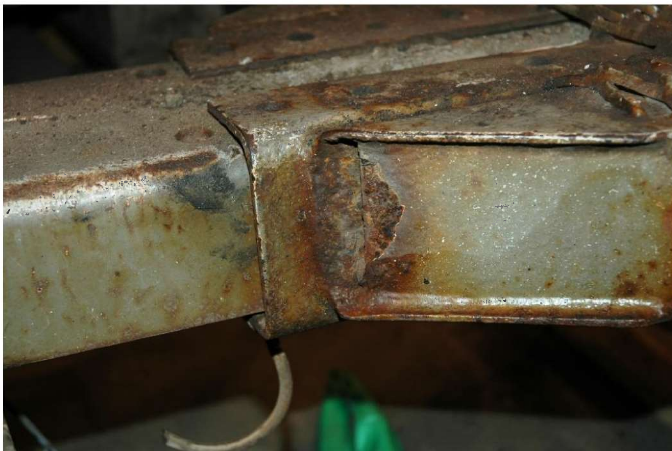
Figur 3 Bilde som viser innsveising av profil til innfestet av draget med åpning som gir fuktinntrenging på insiden av profil.
