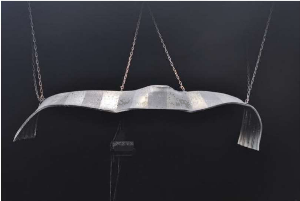
Figur 16 Ett foto taget efter branden av höjdvarningskylten vid tunnelmynningen vid Hamnen (källa: Statens Vegvesen).
